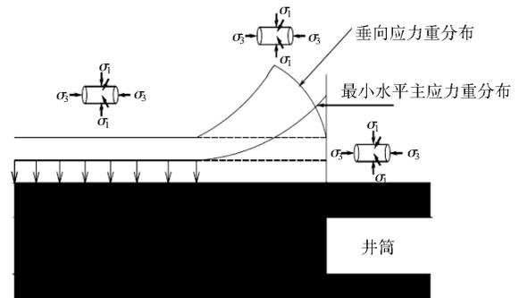
图 1 煤层气水平井地应力 redistribute 条件下井周围岩受力图
