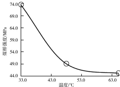
图6 温度-煤样强度关系图
