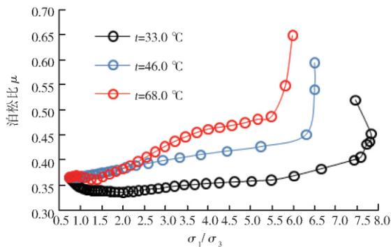
图 4 不同温度下围压与轴压比-泊松比关系图
